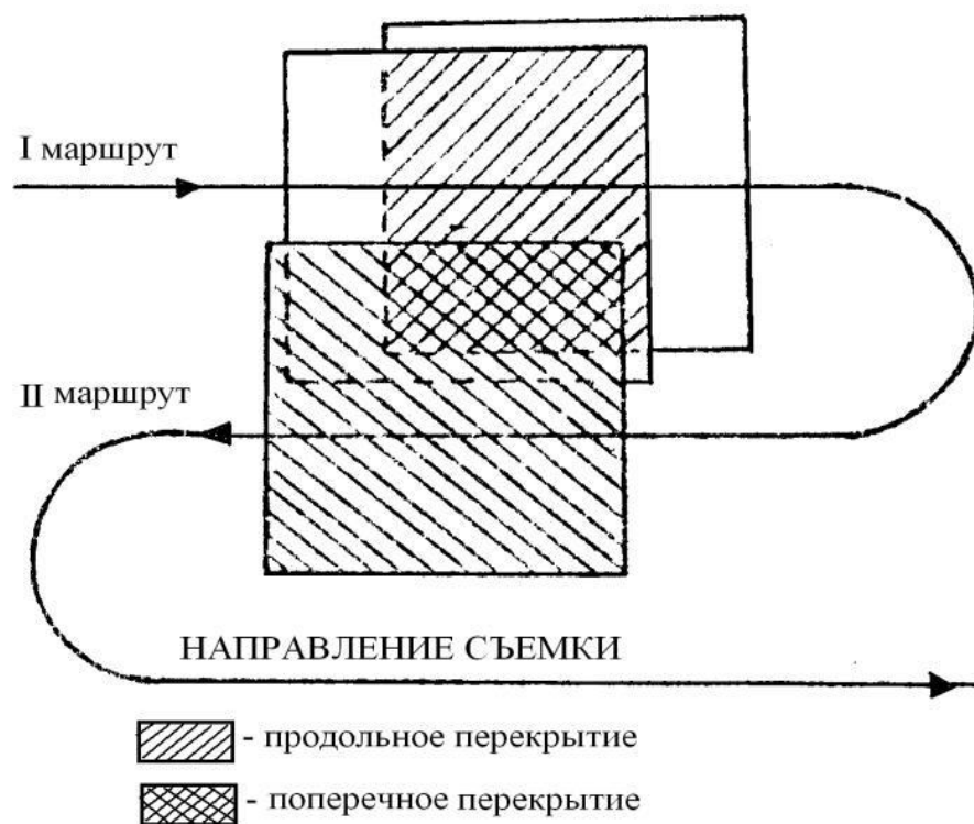
Рисунок 2 – Направление полета при аэрофотосъемке
